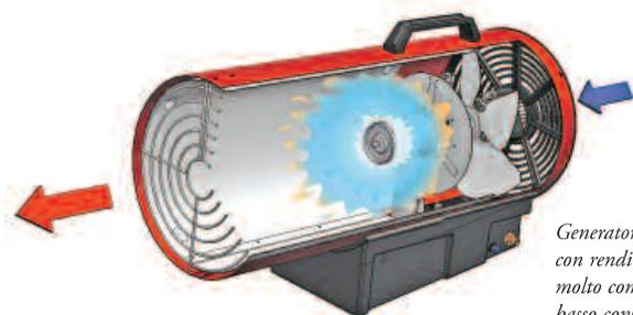
Generatore a gas a combustione diretta con rendimento termico 100% e design molto compatto. Prestazioni elevate e basso consumo di combustibile.
